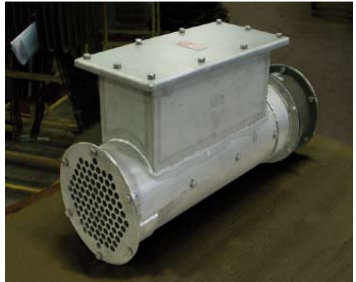
Fan heater for temperature maintenance on mechanisms of heavy vehicles Aérotherme pour maintien en température de mécanismes sur engins
